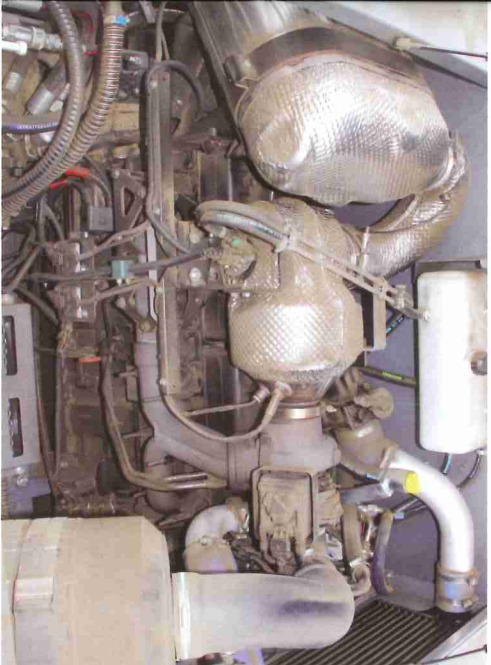
Comia C6 może być wyposażona w silnik cztero- lub sześciocylindrowy. W prezentowanym w Wóhyniu modelu zamontowany był ten drugi o mocy 185 KM.
